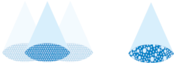
Рис. 2. Конусний тип форми розпилення;
