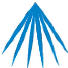
Рис. 7. Струменева форма типу розпилення.
