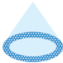
Рис. 5. Форма типу розпилення з пустим конусом
