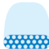
Рис. 3. Форма типу розпилення зі зміною напрямку (Deflect pattern)
