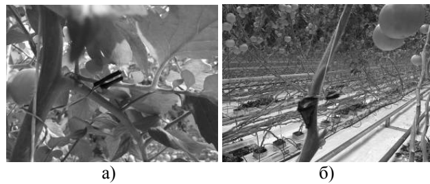
Рисунок 5 – Датчик освітленості - а); датчики температури рослини, повітря та вологості повітря в теплиці - б)
