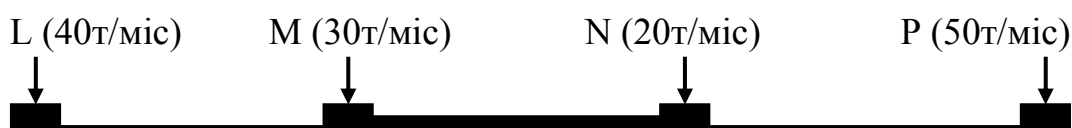
Рис. 4.4 – Визначення оптимального розташування розподільного складу при рівності "лівого" й "правого" вантажооборотів пробної точки
