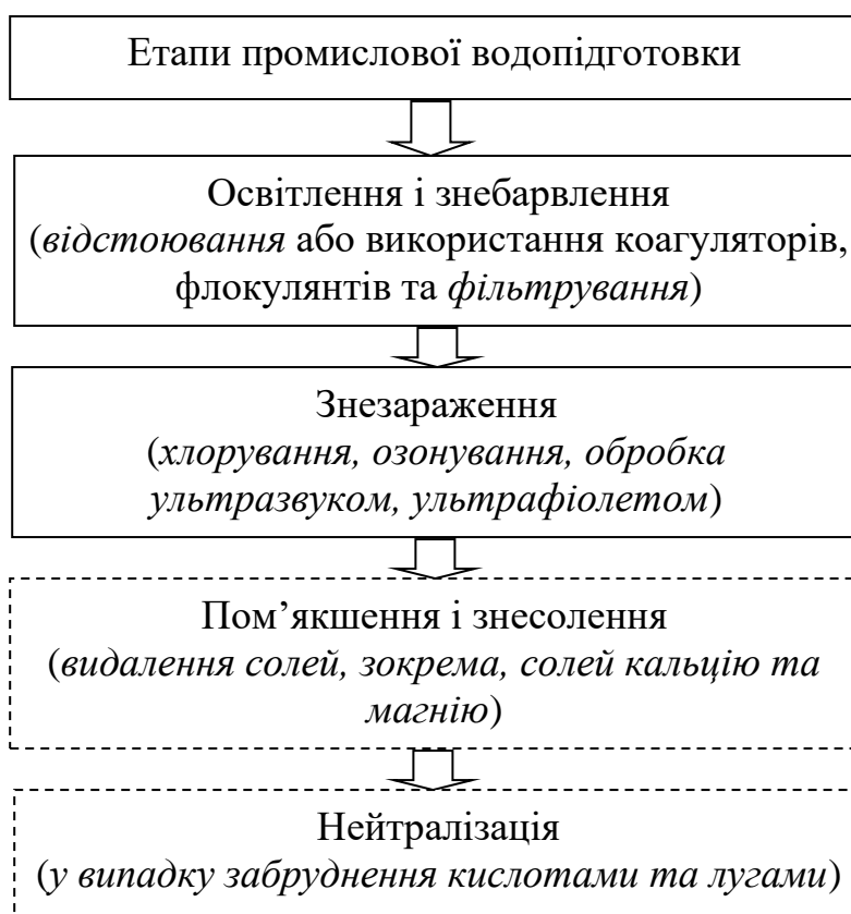
Рис. 2.9. Етапи промислової водопідготовки
