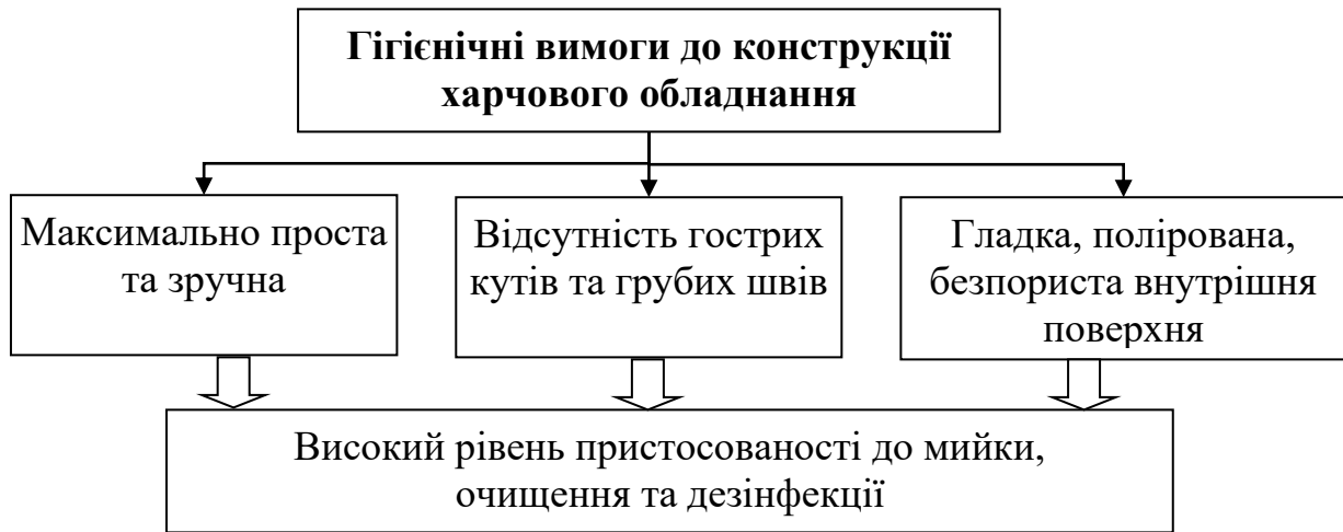
Рис. 4.3. Гігієнічні вимоги до конструкції харчового обладнання
