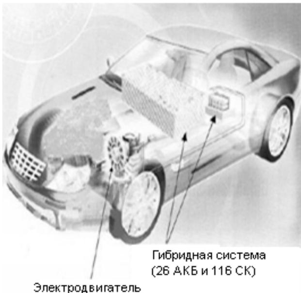
Рисунок 2 – Примерный вид компоновки ЭМ
