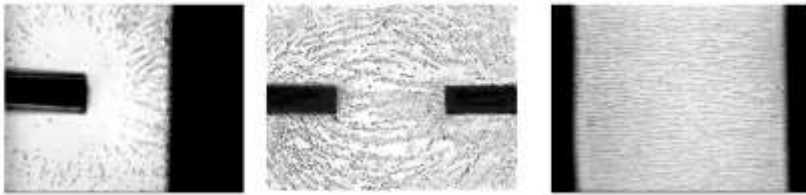
Рис. 23 Візуалізовані силові лінії електричного поля (ланцюжки еритроцитів) між парою МЕ
