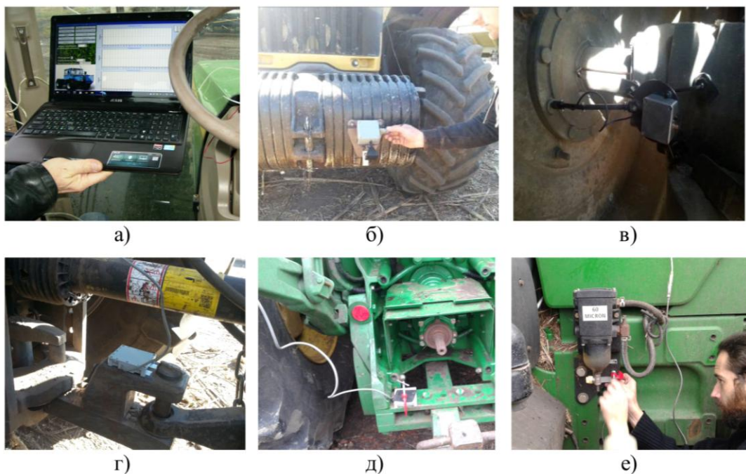
a – загальний вид обчислювального модулю; б – радар (дійсна швидкість); в – датчик обертів колеса (теоретична швидкість); г, д, е – інерційні датчики (прискорення)
