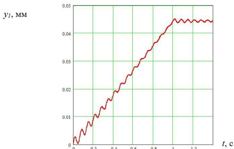
Рис. 5 – Графік зміни лінійної деформації оправки для калібрування в напрямку осі y в часі
