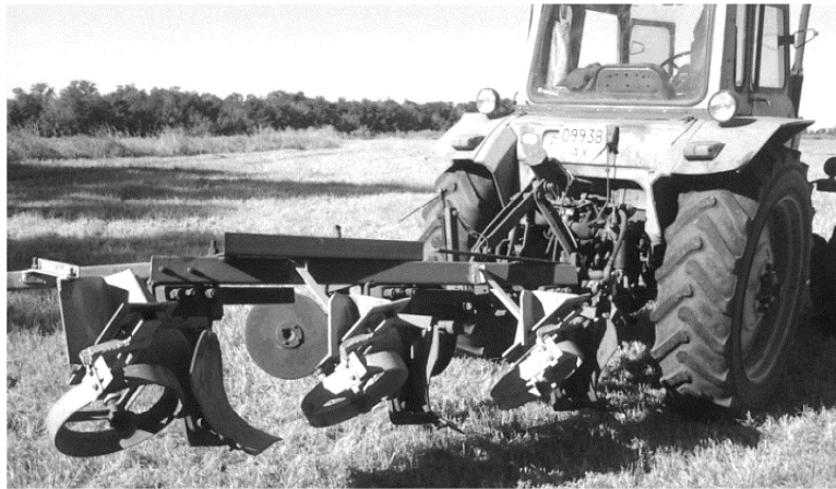
Рис.9 – Експериментальний зразок начіпного плуга ПЛН-3-35 з борозневими колесами, встановленими за кожним корпусом
