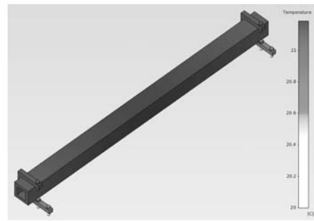
Рисунок 7 – Стаціонарне теплове поле квадратної струмопровідної шини з квадратним отвором з урахуванням конвективного розсіювання теплоти в оточуюче середовище при струмі 250 А
