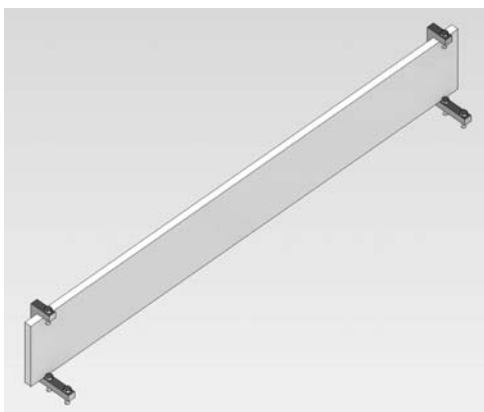
Рисунок 2 – Прямокутна струмопровідна шина 100×10 мм та кріплення до ізолятора ІОР-10-7,5
