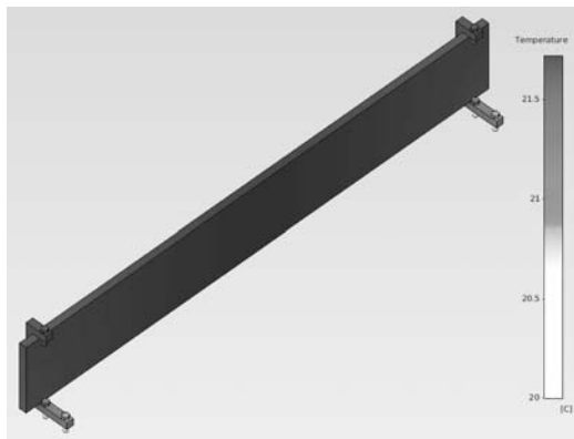
Рисунок 6 – Стаціонарне теплове поле прямокутної струмопровідної шини з урахуванням конвективного розсіювання теплоти в оточуюче середовище при струмі 250 А
