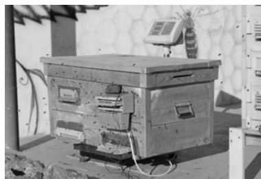
Рисунок 1 - Льоткова приставка з під'єднаним геліоколектором і УФ модулем на світлодіодах
