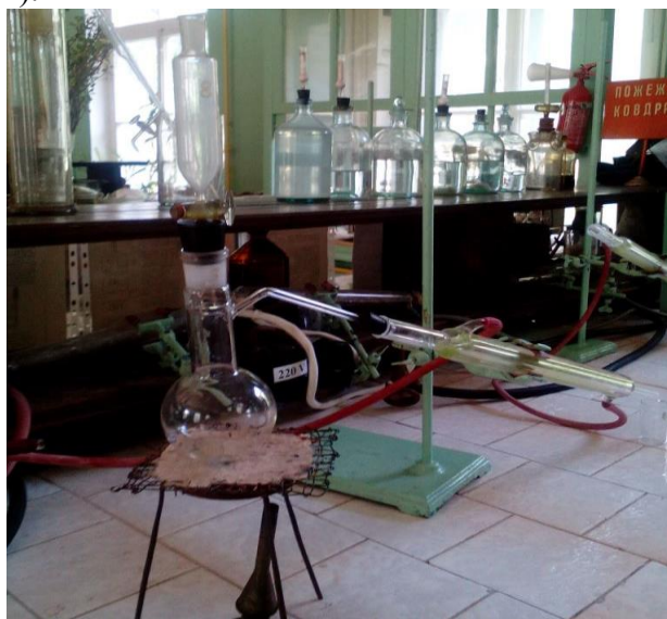
Рисунок 2 – Визначення вмісту пентозанів в деревині бромід-броматним методом
