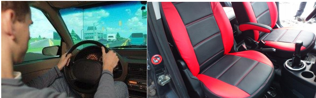
Рис. 7- Вібрація передається через кермо і важіль перемикавання передач - локальна; і через сидіння - загальна
