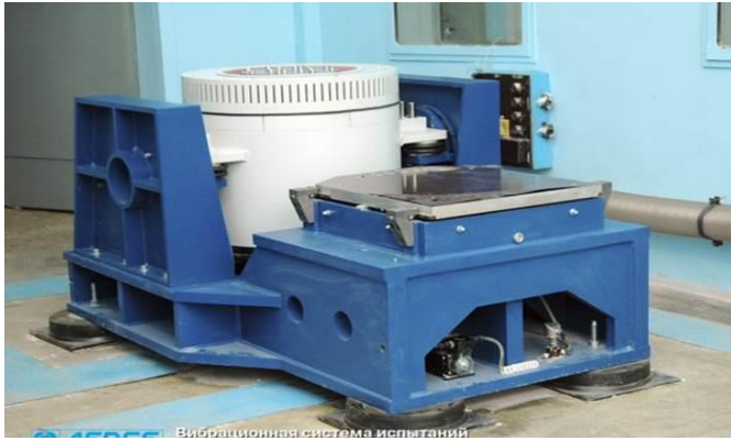
Рис. 37 - Установка верстата на гумові амортизатори для захисту від вібрації
