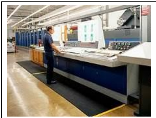
Рис.39- Гумовий килимок біля стаціонарного обладнання знижує дію вібрації
