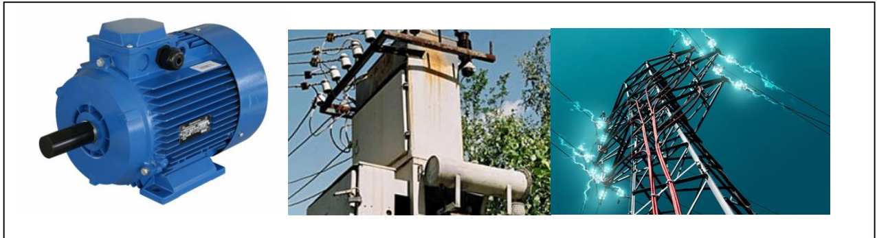
Рис. 2- Шум електромагнітного походження: від електромотора, трансформатора, високовольтних ліній електропередач
