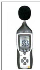
Рис. 11- Вимірювач рівня шуму (шумомір) моделі DT8851/8852 є одним з найбільш функціонально оснащених професійних шумомірів.
