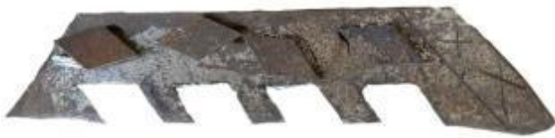
Рисунок 3 – Поверхня лемішу з вирізами під вставки
