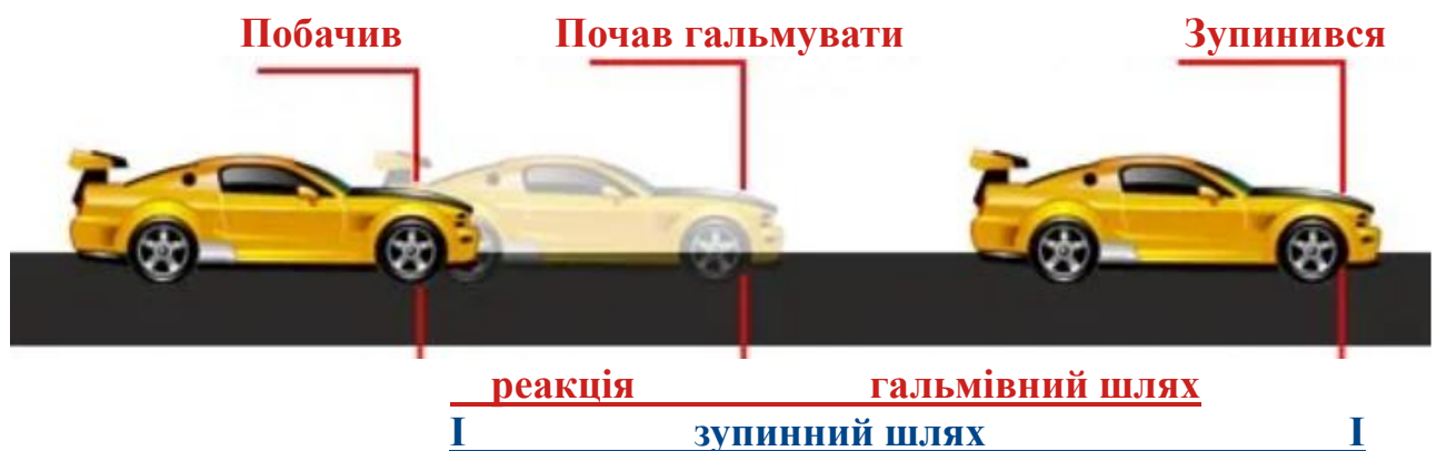
Рисунок 2.1 — Складові зупинного шляху
