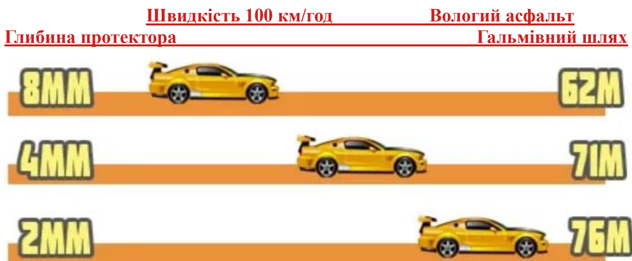
Рисунок 2.2 — Залежність гальмівного шляху від глибини протектора
