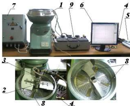
Рисунок 1 – Стенд для визначення навантажувальної здатності протиральних машин на базі машини МПР-350: 1 – машина протирально-різальна МПР-350; 2 – ротор; 3 – струмознімач; 4 – підсилювач; 5 – аналого-цифровий перетворювач; 6 – персональний комп’ютер; 7 – частотний перетворювач; 8 – тензодатчики КФ5П1-3-200-Б-12; 9 – вимірювальний комплекс К-50
