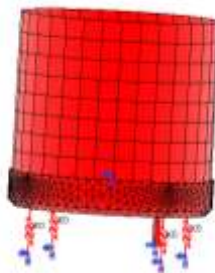
Рисунок 1 – Кінцевоелементна модель картоплечистки МОК-150
