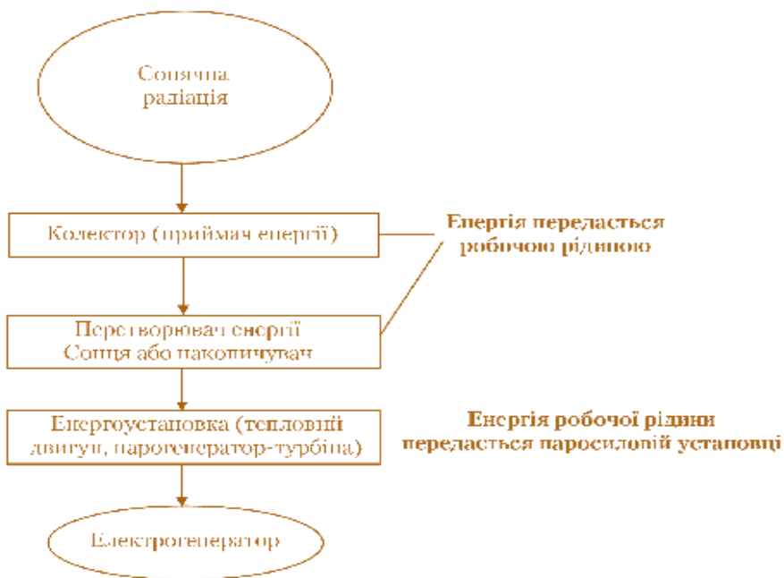
Рис. 1 - Принципова блок-схема сонячної теплоелектростанції
