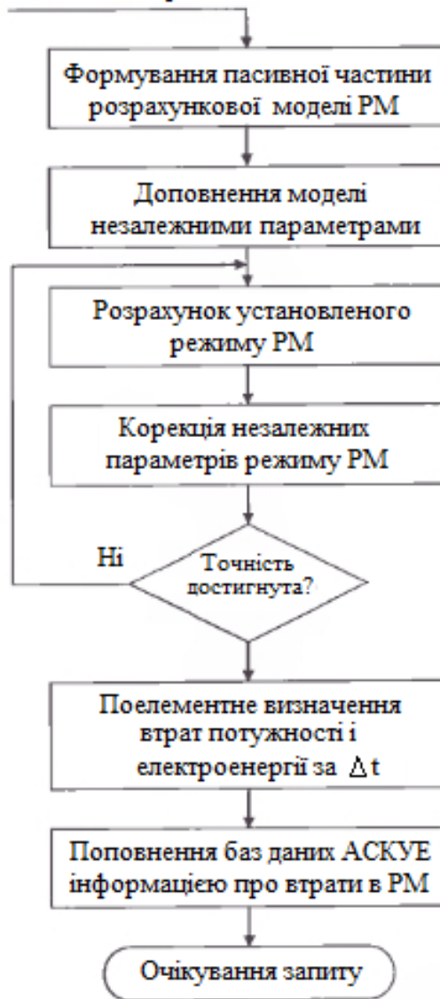
Рисунок 7.5 – Структура визначення втрат потужності та електроенергії в мережі 0,38 кВ з використанням АСКУЕ
