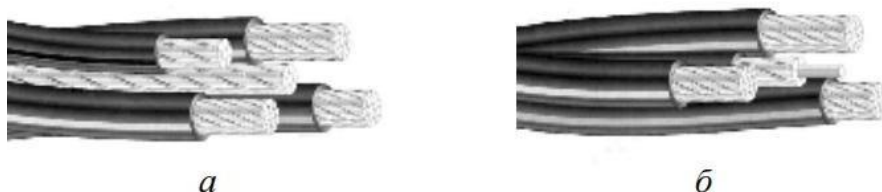
Рисунок 6. 9 – Самоутримні ізольовані проводи: a – СП-1; б – СП-1А.
