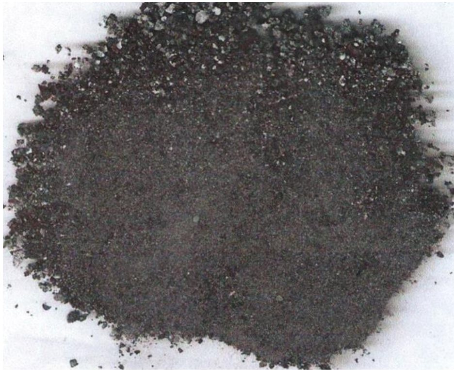
Рис. 1. Змішана дрібна фракція магнітної і немагнітної шихти від утилізації боєприпасів
