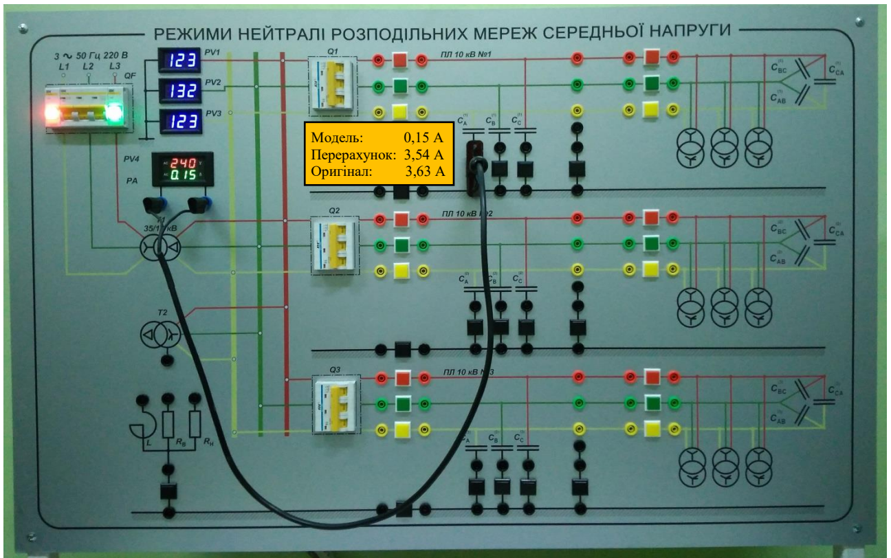
Рисунок 3.1 – Загальний вигляд лабораторного стенда квазіфізичної моделі розподільної електричної мережі 10 кВ під час моделювання нормального режиму
