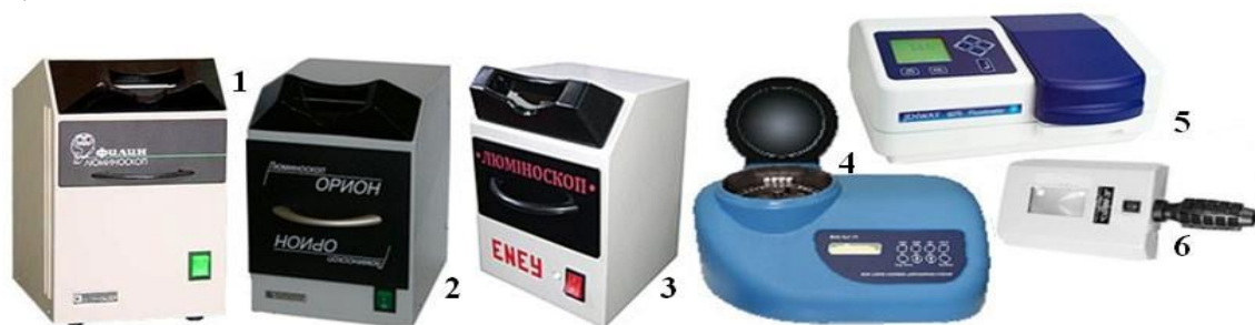
Рис. 51– Люміноскопи: 1 – Філін, 2 – Оріон, 3 – Еней; Аналізатори люмінесцентні мультиканальні: 4 – АІА-1/4, 5 – Jenway 627-001; 6 – Опромінювач люмінесцентний Сапфир-2В
