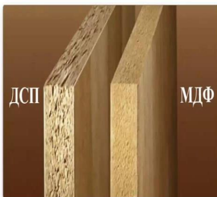
Рис. 32 – Порівняння структури МДФ та ДСП
