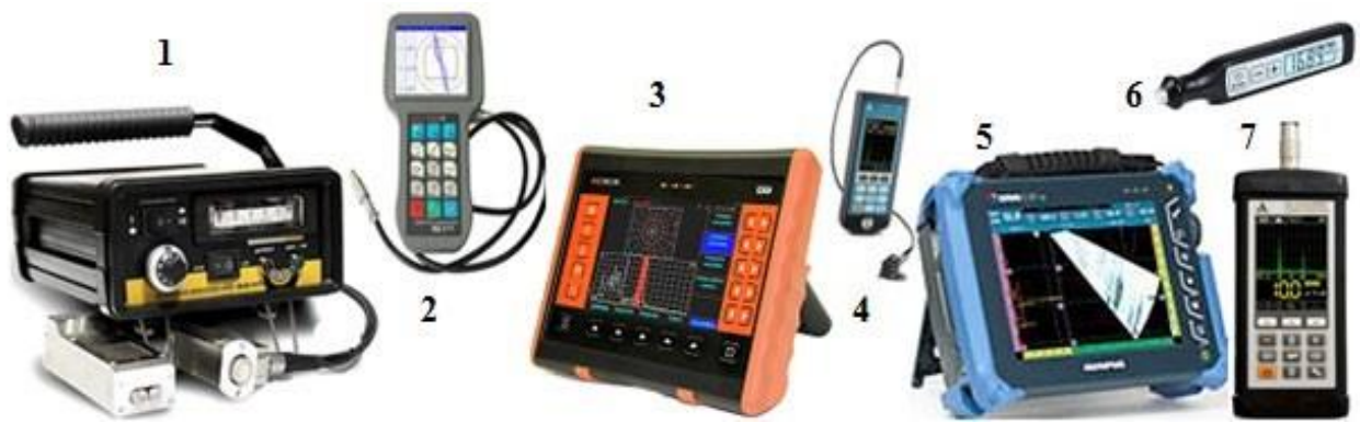
Рис. 60 – Дефектоскопи: 1 – імпульсний імпедансний ІД-92НМ, 2 – вихореструмний ВД3-71, 3 – акустичний АД-60К, 4 – мініатюрний ультразвуковий А1211 MINI, 5 – ультразвуковий OMNISCAN SX; Товщиноміри: 6 – ультразвуковий А1207, 7 – електромагнітно-акустичний А1270
