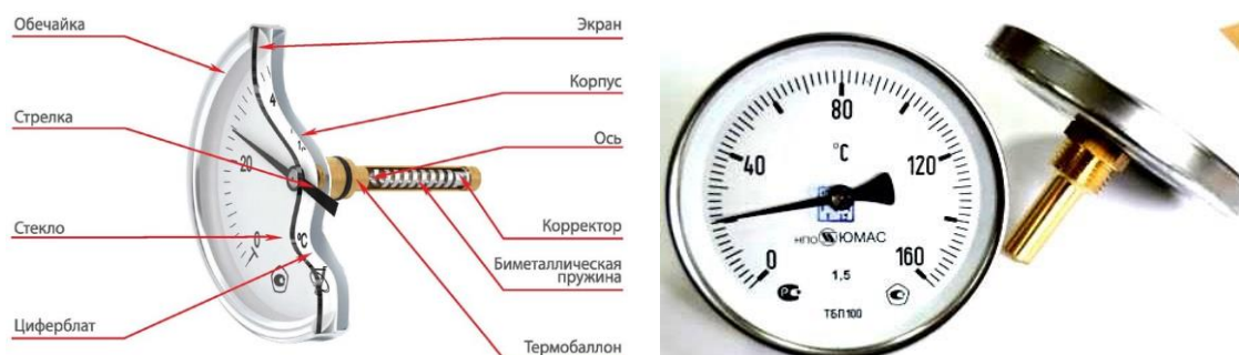
Рис. 48 – Термометри біметалічні
