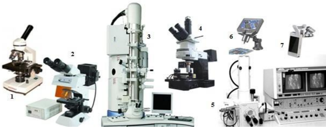
Рис. 54 – Мікроскопи: 1 – біологічний, 2 – люмінесцентний, 3 – трансмісійний електронний, 4 – атомно-силовий, 5 – скануючий електронний, 6 – портативний, 7 – для смартфона
