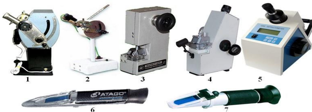
Рис. 50 – Рефрактометричні прилади: 1 – рефрактометр РПЛ-4, 2 – рефрактометр УРЛ-1, 3 – рефрактометр ИРФ-456 КАРАТ МТ, 4 – рефрактометр ИРФ-454Б2М, 5 – рефрактометр цифровий Abbe WAY-2S, 6 – рефрактометр ручний Master-4alpha (Atago), 7 – рефрактометр ручний VMK2
