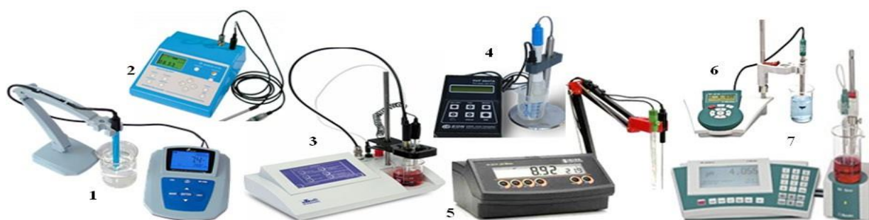
Рис. 58 – рН-метри: 1 – МР 511, 2 – АНИОН 4100, 3 – Итан, 4 – РНТ-004 ТА, 5 – Metrohm 780, 6 – рН 827 lab, 7 – 2211 Hanna
