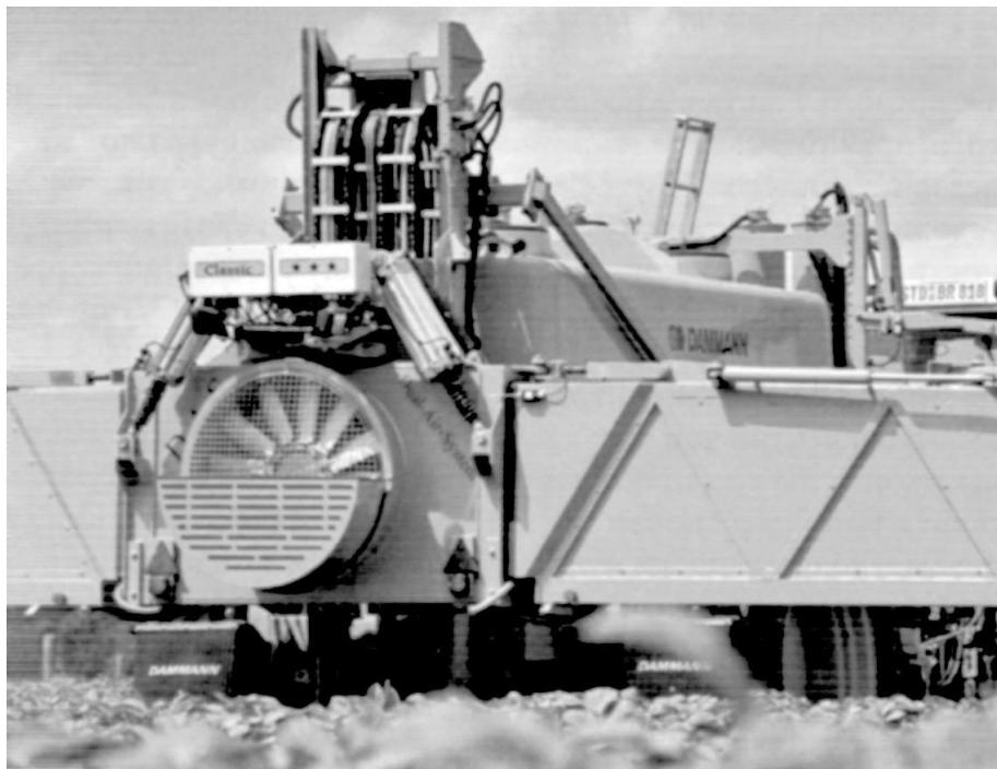
Рис.35. Зовнішній вигляд Dual-Air-системи і його вентилятора на штангах обприскувачів Dammann «Подвійний удар» за один прохід
