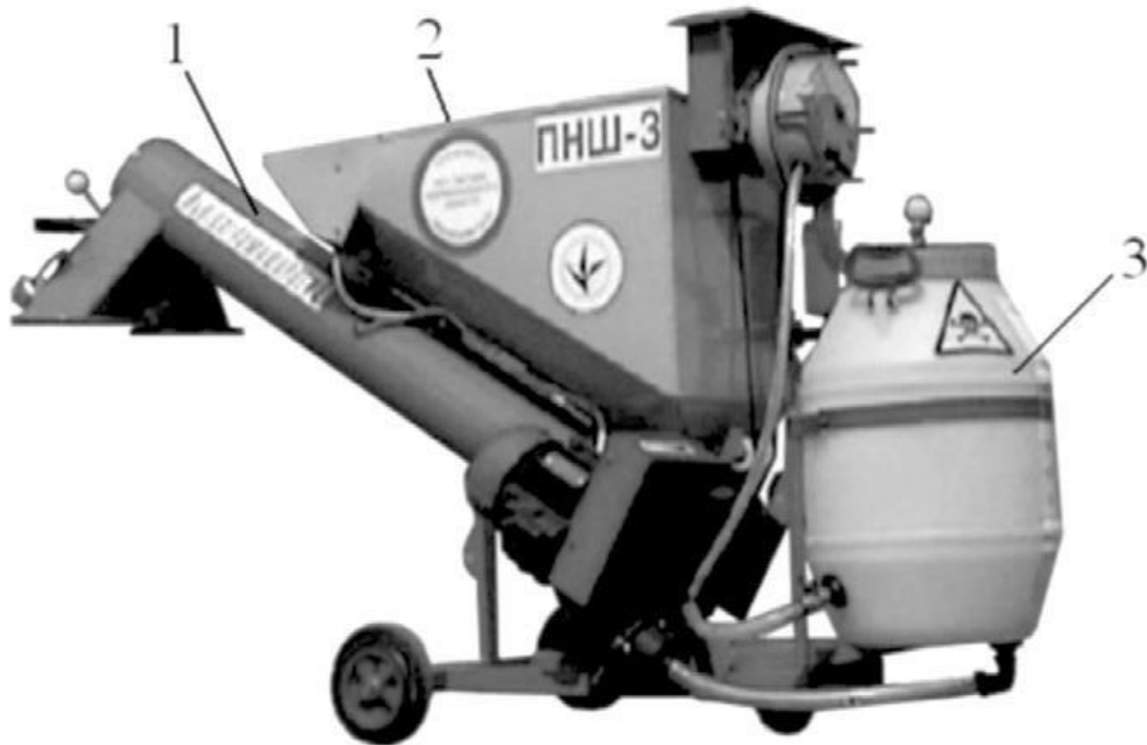
Рис. 3. Протруювач ПНШ-3 «Фермер»: 1 – шнек; 2 – бункер; 3 – бак
