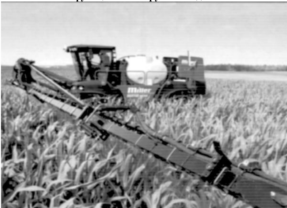
Рис. 40. Легка передня штанга обприскувача Miller Nitro 4240 швидко складається на ходу перед розворотом уздовж лісосмуги і так же швидко розвертається
