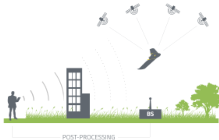
Рисунок 2 – Тип системи управління з використанням РРК технології [2]
