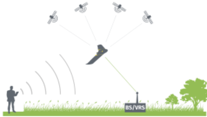
Рисунок 1 – Тип системи управління з використанням RTK технології [2]
