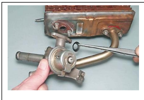
Рис. 20 - Установка кільця ущільнювача на фланець обладнання
