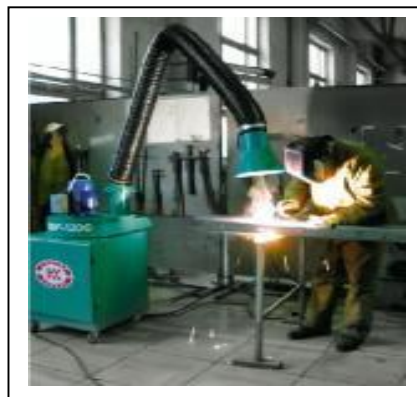
Рис. 14 - Робоче місце газозварника: з витяжним зондом (зліва) і з місцевою витяжною вентиляцією (праворуч)
