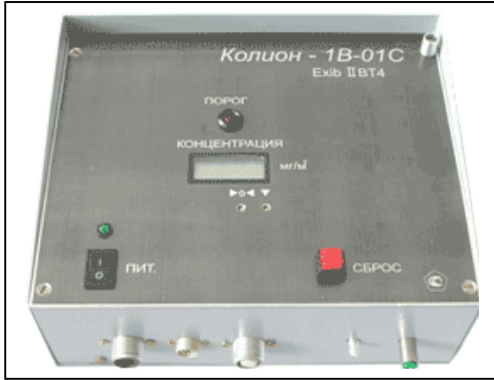
Рис. 9 - Стационарні газоаналізатори аміаку: зліва направо: Коліон-1В-01С, Хоббіт-Т-ННЗ
