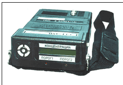
Рис.3 - РГД-35И - переносний оптичний газоаналізатор горючих газів
