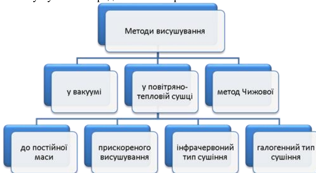
Рис. 3.2 – Класифікація методів визначення вологості висушуванням.
