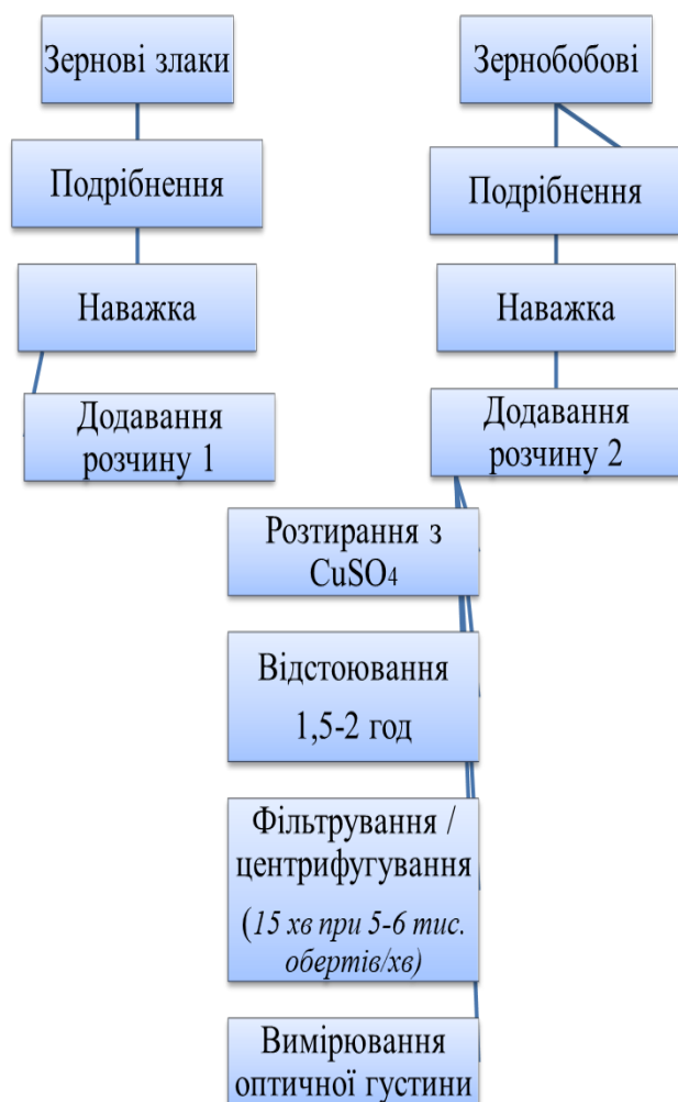
Рис. 6.2 – Алгоритм визначення масової долі білку біуретовим методом
