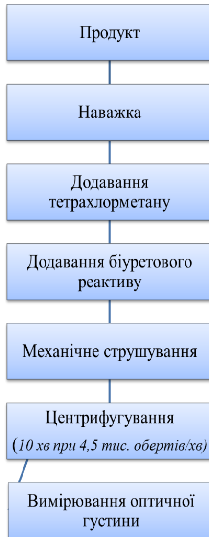
Рис. 6.3 – Алгоритм визначення масової частки білку біуретовим методом
