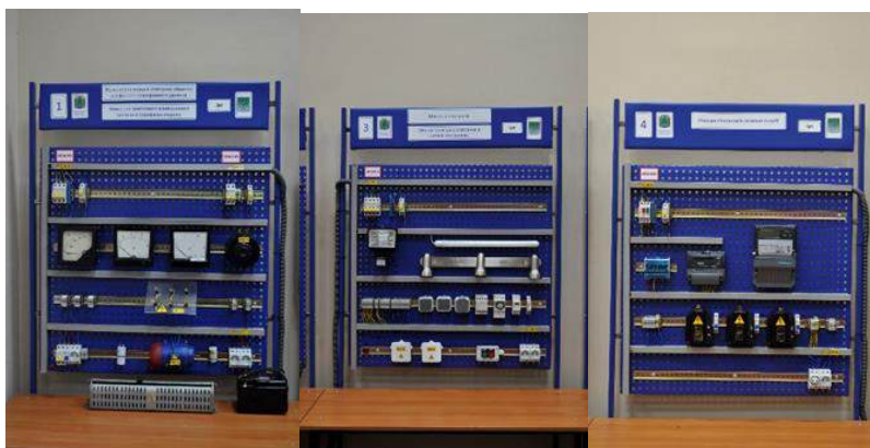
Рис. 1. Монтаж комутаційно-захисних апаратів, освітлення та лічильника
