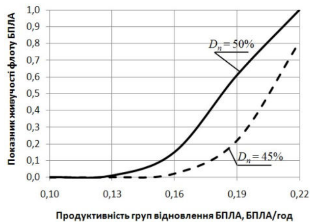
Рисунок 1 – Залежність показника живучості флоту БПЛА від продуктивності груп відновлення для припустимих рівнів збитків флоту у 45% та 50% БПЛА, втрачених внаслідок впливу НФ:
