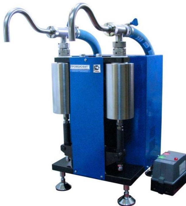
Рисунок 2.5 – Установка розливу рідких і пастоподібних продуктів: 1 – бак об'ємом 45 л; 2 – опора; 3 – дозатор для рідких і пастоподібних продуктів УД-2; 4 – вихідний штуцер бака; 5 – шланг армований пластмасовий; 6 – трубка; 7 – шланг рівнеміра
