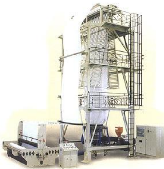
Рисунок 6.2 – Установка для виробництва плівки рукавним методом із прийманням рукава вгору
