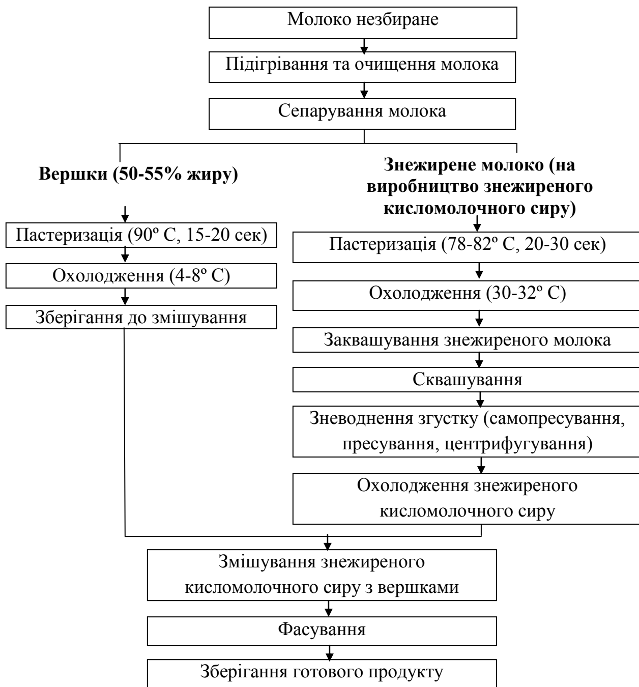
Рисунок 5.2 – Технологічна схема виробництва кисломолочного сиру роздільним способом
