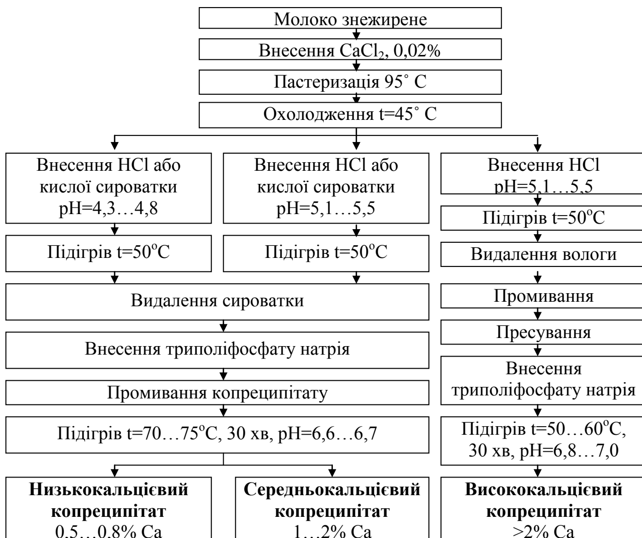
Рисунок 5.5 – Технологічна схема виробництва копреципітату
