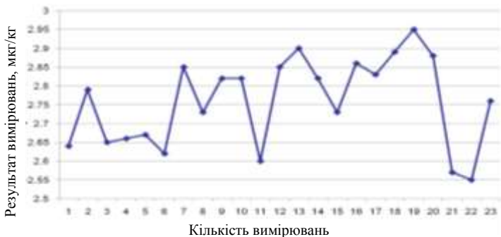
Рисунок 4 – Результати досліджень контрольного зразка олії соняшникової за допомогою аналізатора Agilent 1200
