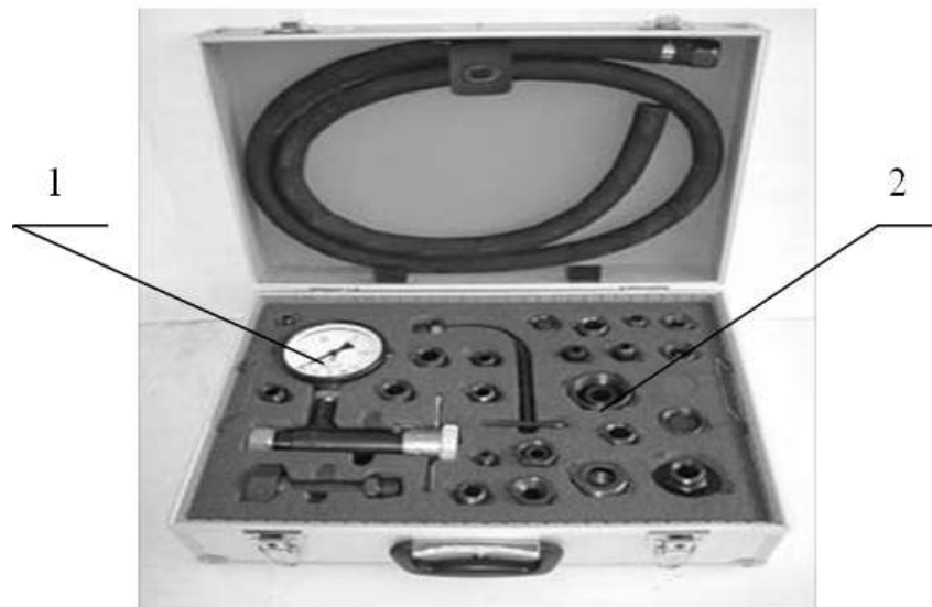
Рис. 12 – Комплект КИ-5473.01 для діагностування гідроагрегатів тракторів: 1 – дросель-витратомір ДР-90; 2 – комплект переходників і шлангів
