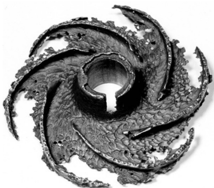
Рисунок 1 – Руйнування колеса внаслідок кавітації
