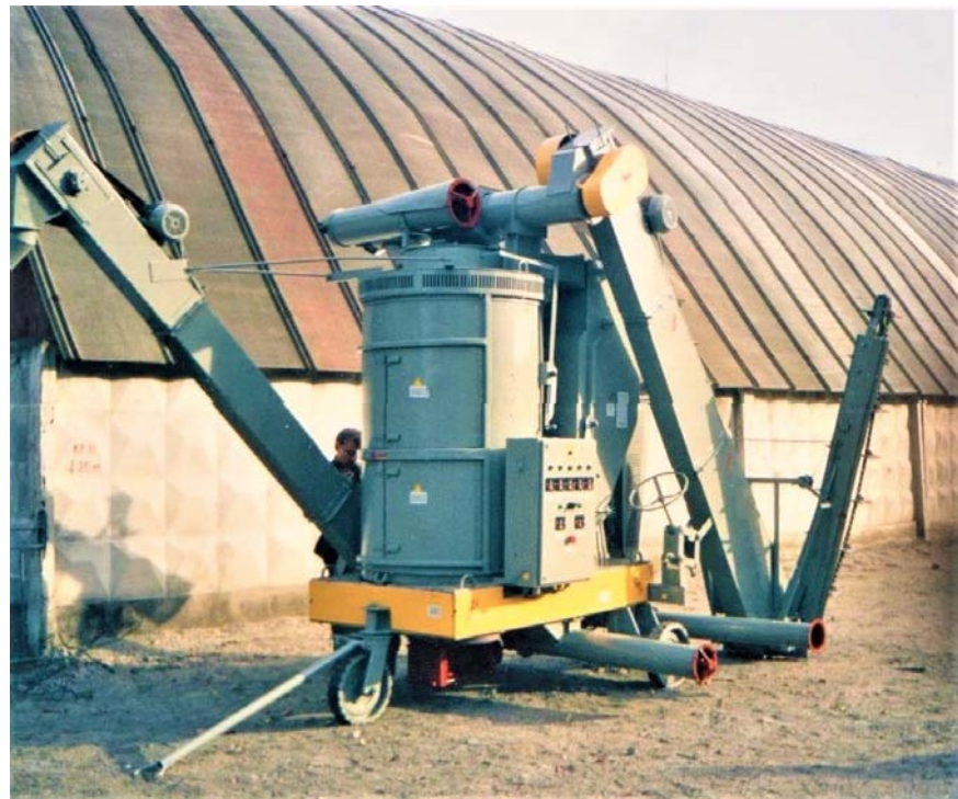
Рис. 6. Загальний вид модифікованого самопересувного вібропневмовідцентрового сепаратора А1-БЦС-100
