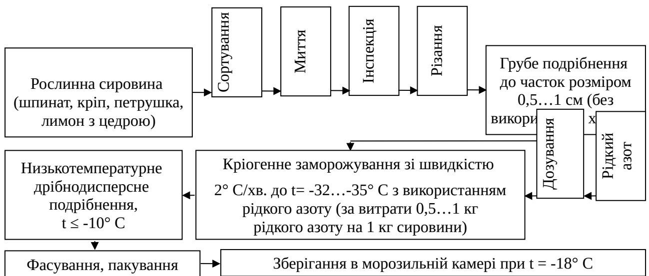
Рис. 4.2 – принципова технологічна схема виробництва нанодобавок
