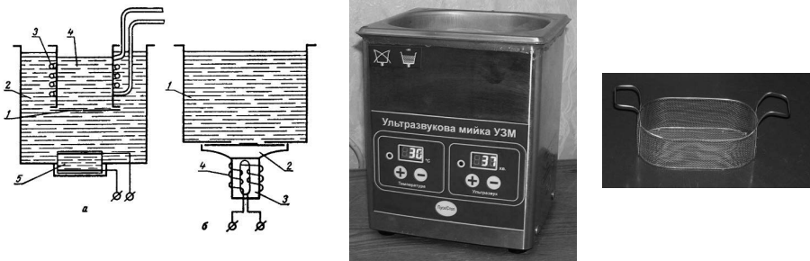
Рис. 6.13 Схеми ванн для ультразвукового миття, зовнішній вид установки та кошик для деталей: а – з п'єзокварцевим випромінювачем 1 – діафрагма; 2 – проміжне середовище (трансформаторне масло); 3 – нагрівальний змійовик; 4 – ванна з миючим розчином; 5 – п'єзокварцевий випромінювач; б – з магнітострикційним випромінювачем; 1 – миючий розчин; 2 – трансформатор ультразвукових коливань; 3 – перетворювач; 4 – обмотка.
