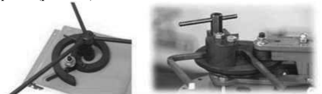
Рис. 4.45 Згинання металу квадратного профілю за допомогою обкатного ролика
