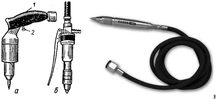
Рис. 2.36 Кернери: а – пневматичний «пістолет»; б – пневматичний портативний; в – кернер пневматический ВАНСО (БАХКО) ВР799
