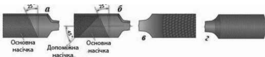
Рис. 4.27 Насічки напилків: а – одинарна (проста); б – подвійна (перехресна); в – точкова (рашпільна); г – дугова.
