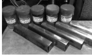
Рис. 5.10 Комплект для ручного притирання, що складається з чавунних притирів і алмазної пасты різної зернистості
