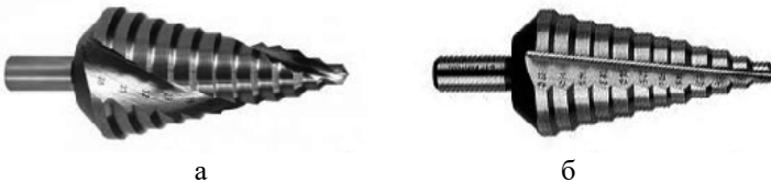
Рис. 3.3 Спіральні свердла: а – зі спіральною канавкою, б – з прямою канавкою
