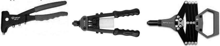
Рис. 6.41 Заклепочники: а – одnorучні; б – дворучні; в – кулісні
