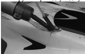
Рис. 6.56 Проведення спаювання елементів пластикової деталі
