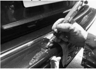
Рис. 6.54 Паяння пластикових деталей за допомогою нагрівальних елементів
