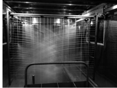
Рис. 6.9 Однокамерна установка для очищення: 1 – підвідний патрубок; 2 – приєднувальний штуцер; 4 – перфорована труба; 5 – насадка; 6 – візок
