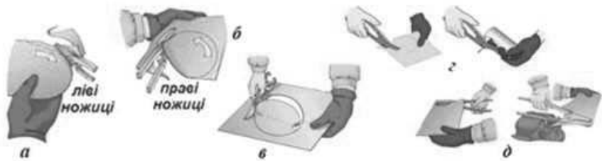
Рис. 4.18 Прийоми розрізання металу ручними ножицями: а – розрізання металу лівими ножицями, б – розрізання металу правими ножицями, в, г – вирізання отвору по розмічальних рисках; д – різання листової заготовки на вузькі смуги
