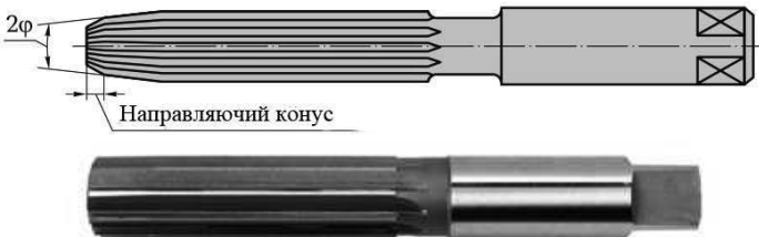
Рис. 3.14 Розгортка для ручного розгортання: 2\phi – кут загострення конусу
