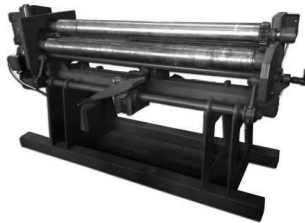
Рис. 4.60 Тривалкова листогибочна машина - гвинтові преси
