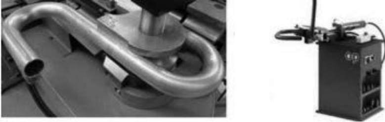
Рис. 4.46 Згинання труби на трубозгинальних верстатах
