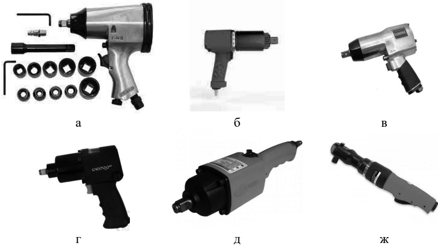
Рис. 6.23 Зовнішній вигляд пневматичного гайковерта: а – ударного; б – безударного; в – посиленого; г – побутового; д – прямого; ж – кутового
