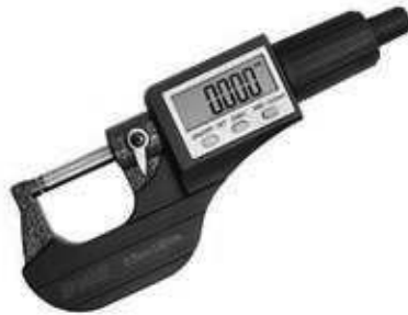
Рис. 1.13. Мікрометри, мікрометричні головки, мікрометр із цифровою індикацією: а – мікрометр 0-25мм; б – мікрометрична головка з верхньою межею виміру до 100 мм: 1 – мікрометричний гвинт; 2 – стебло; 3 – барабан; 4 – мікрогайка; 5 – стяжна гайка; 6 – накидний ковпачок; 7 – тріскачка; 8 – гвинт кріплення тріскачки; 9 – палець; 10 – пружина; 11 – втулка; 12 – гвинт; в – з мікрометричною головою з верхньою межею вимірювань понад 100 мм: 1 – мікрометричний гвинт; 2 – стопорна гайка; 3 – розрізна втулка; 4 – барабан; 5 – настановний ковпачок; 6 – палець; 7 – тріскачка; г – мікрометр із цифровою індикацією
