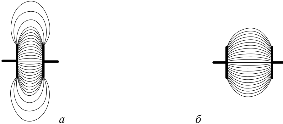
Рис. 3.3 – Силкові лінії електричного поля, утвореного двома пластинами: а – при відстані між пластинами меншого їх діаметра; б – при відстані між пластинами більшого їх діаметра
