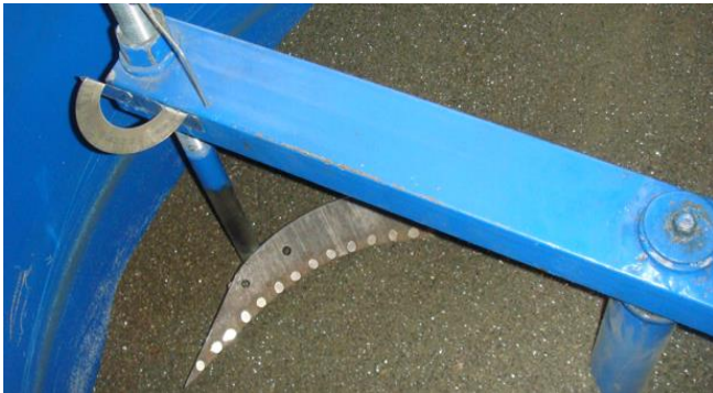
Рис.1. Круговий стенд для випробування експериментальних зразків з криволінійною формою та локальним зміцненням леза
