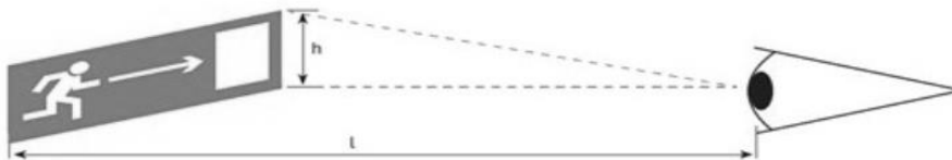
Рис. 19 – Визначення відстані розрізнення знаку безпеки
