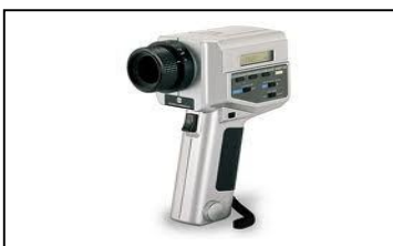
Рис.14 - Портативний яскравомір Konica Minolta
