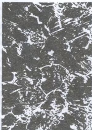
Рис. 1. Микроструктура литого белого чугуна: а – немодифицированный чугун; б – чугун, модифицированный Ce и Ca. Травление 4% раствором азотной кислоты в этиловом спирте; а, б х 100
