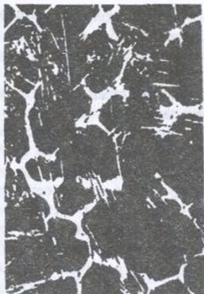
Рис. 1. Микроструктура литого белого чугуна: а – немодифицированный чугун; б – чугун, модифицированный Ce и Ca. Травление 4% раствором азотной кислоты в этиловом спирте; а, б х 100
