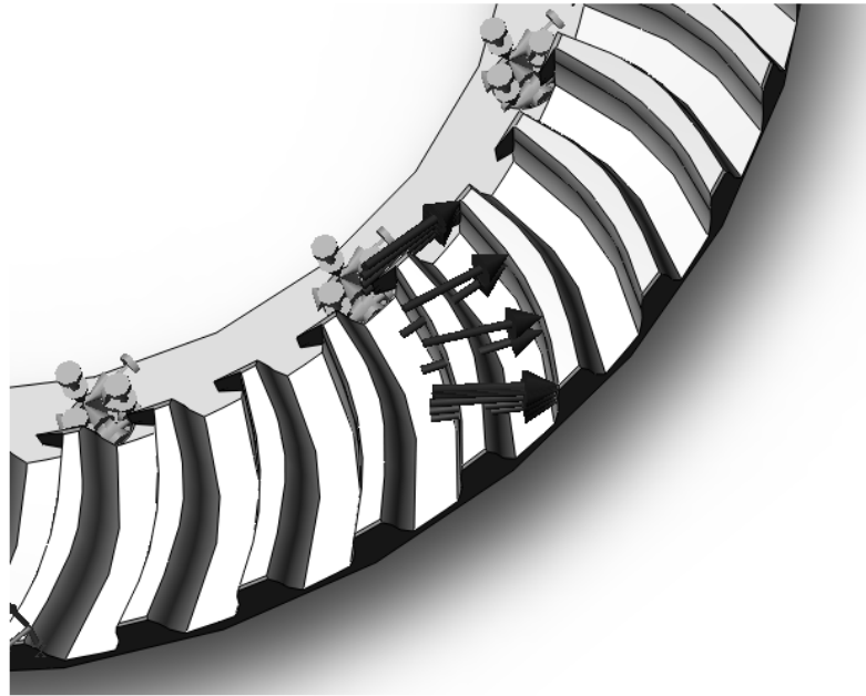
Рис.2 – Схема навантаження ведомої шестерні головної передачі трактора ХТЗ-17221
