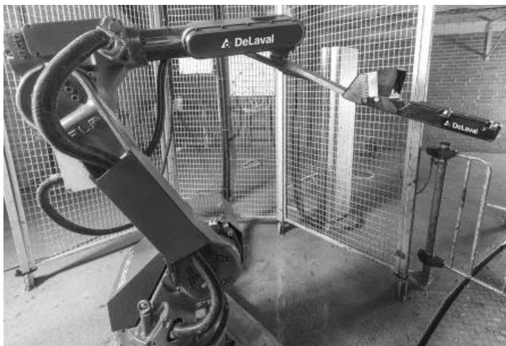
Рис. 6 – Робот для обробки дійок вимені після доїння
