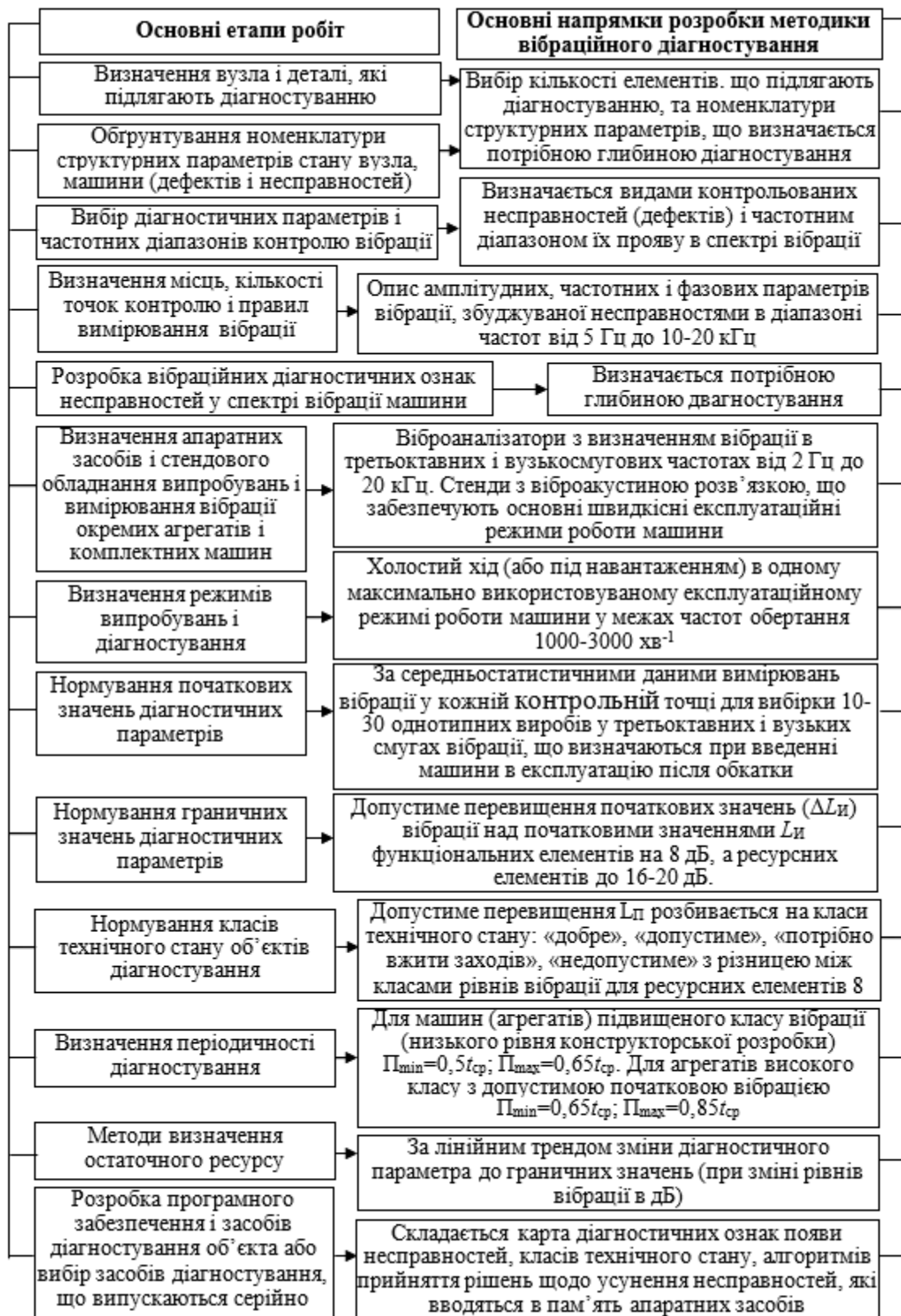
Рис. 5.1. Структурна схема розробки методики вібраційного діагностування технічних систем машин
