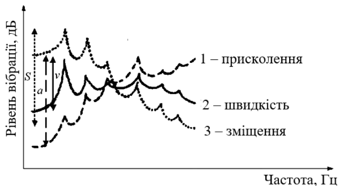
Рис. 3.13. Типовий спектр вібрації машини, виражений у прискоренні, швидкості та зміщенні:
