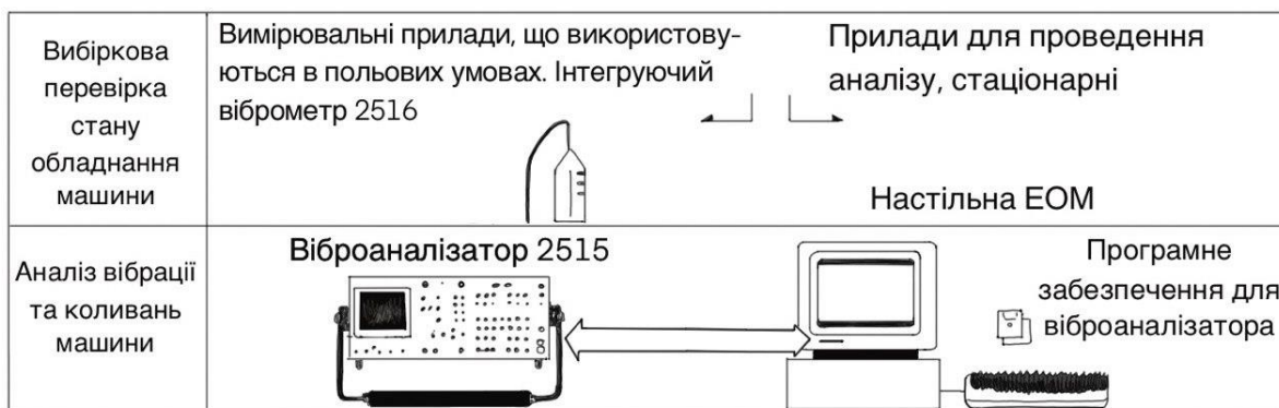
Рис. 4.18. Засоби аналізу вібрації та діагностування машин у польових і лабораторних умовах
