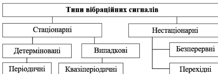
Рис. 3.3. Класифікація типів сигналів вібраційних процесів
