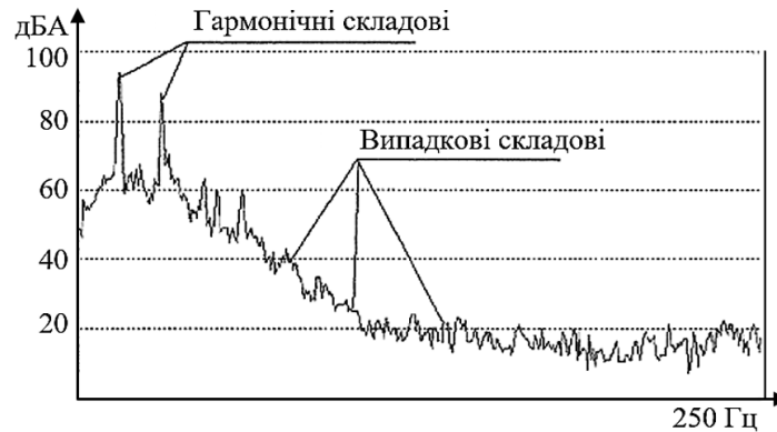
Рис. 2.16. Спектр сигналу вібрації
