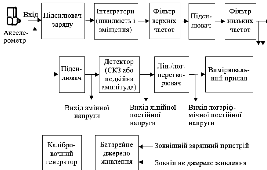
Рис. 4.16. Блок-схема конструкції й принципу дії віброметра
