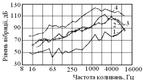
Рис. 2.35. Спектрограми віброприскорення тракторних агрегатів та машинного обладнання
