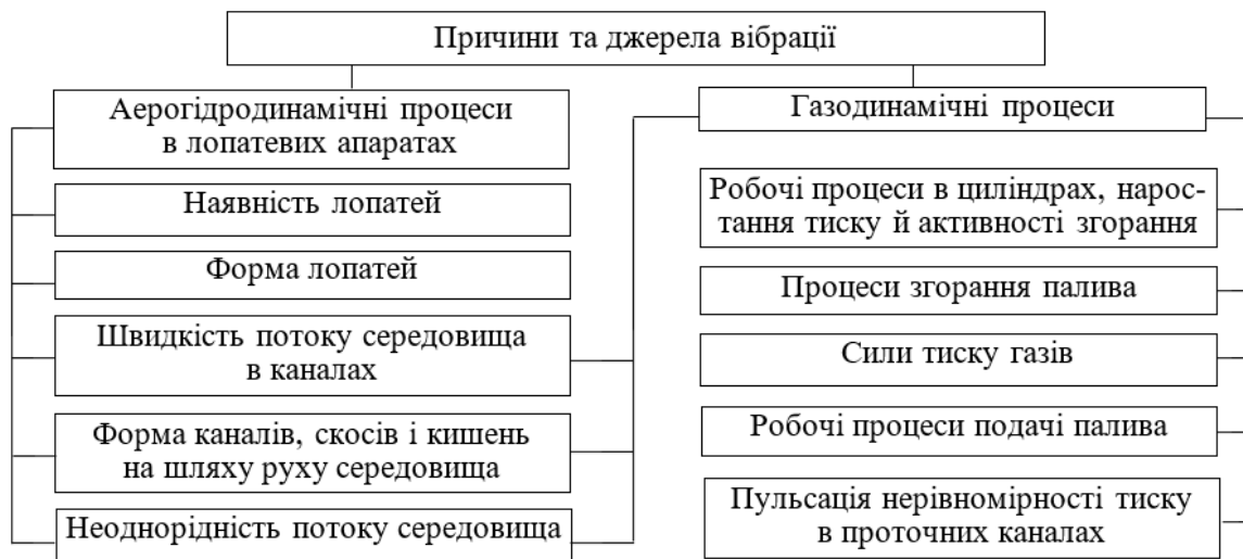
Рис. 2.30. Причини і джерела вібрації аеродинамічного та газодинамічного походження
