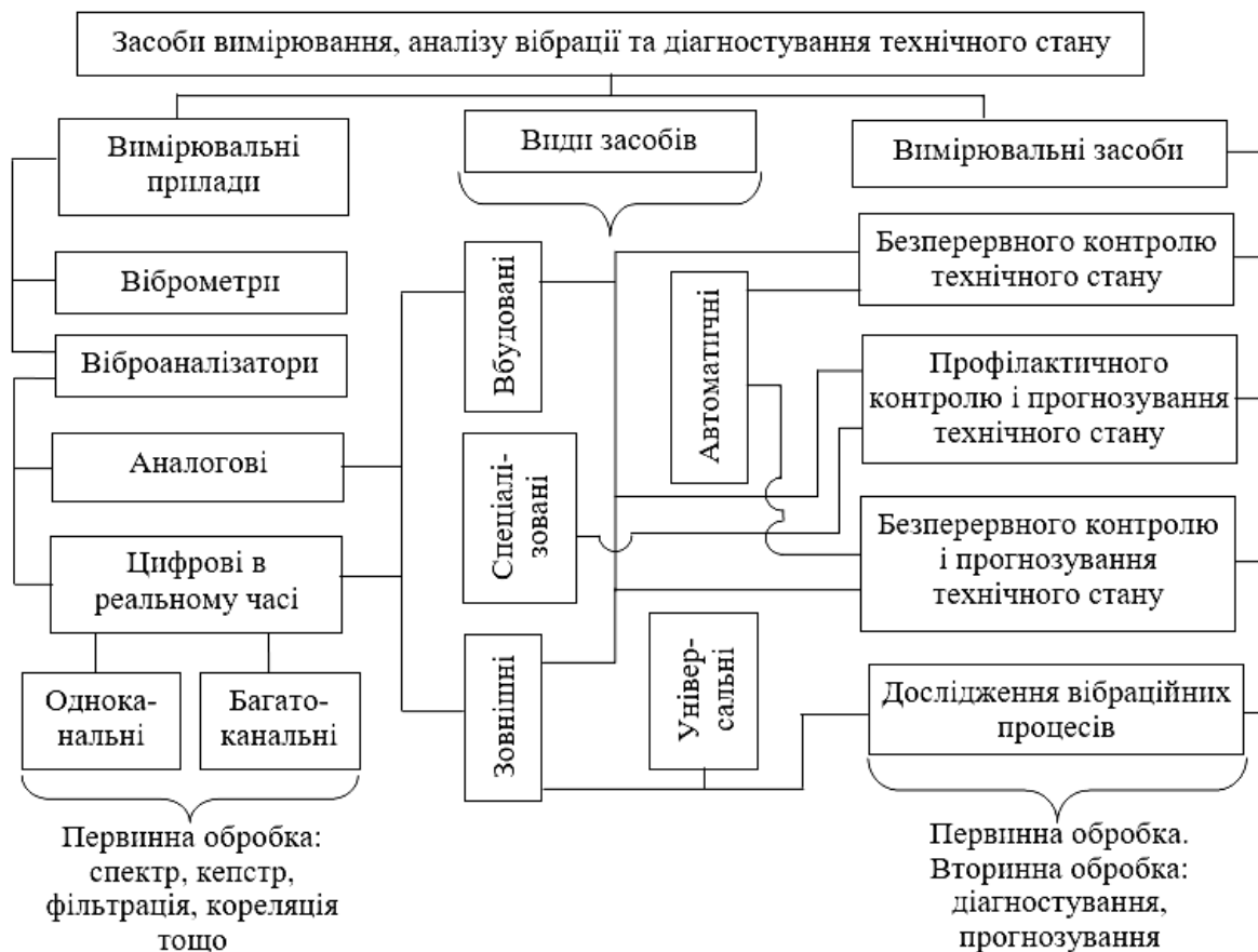
Рис. 4.2. Класифікація засобів вимірювання вібрації та діагностування механізмів за ступенем автоматизації, можливостями аналізу і функціональним призначенням
