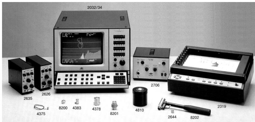
Рис. 7.21. Апаратні засоби й обладнання вібраційних досліджень машин
