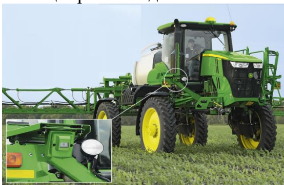
Рис. 2.19 - Система AutoTrac Vision: дисплей GreenStar 3 2630, приймач StarFire 6000, камера AutoTrac Vision, активація RowSense, датчики RowSense
