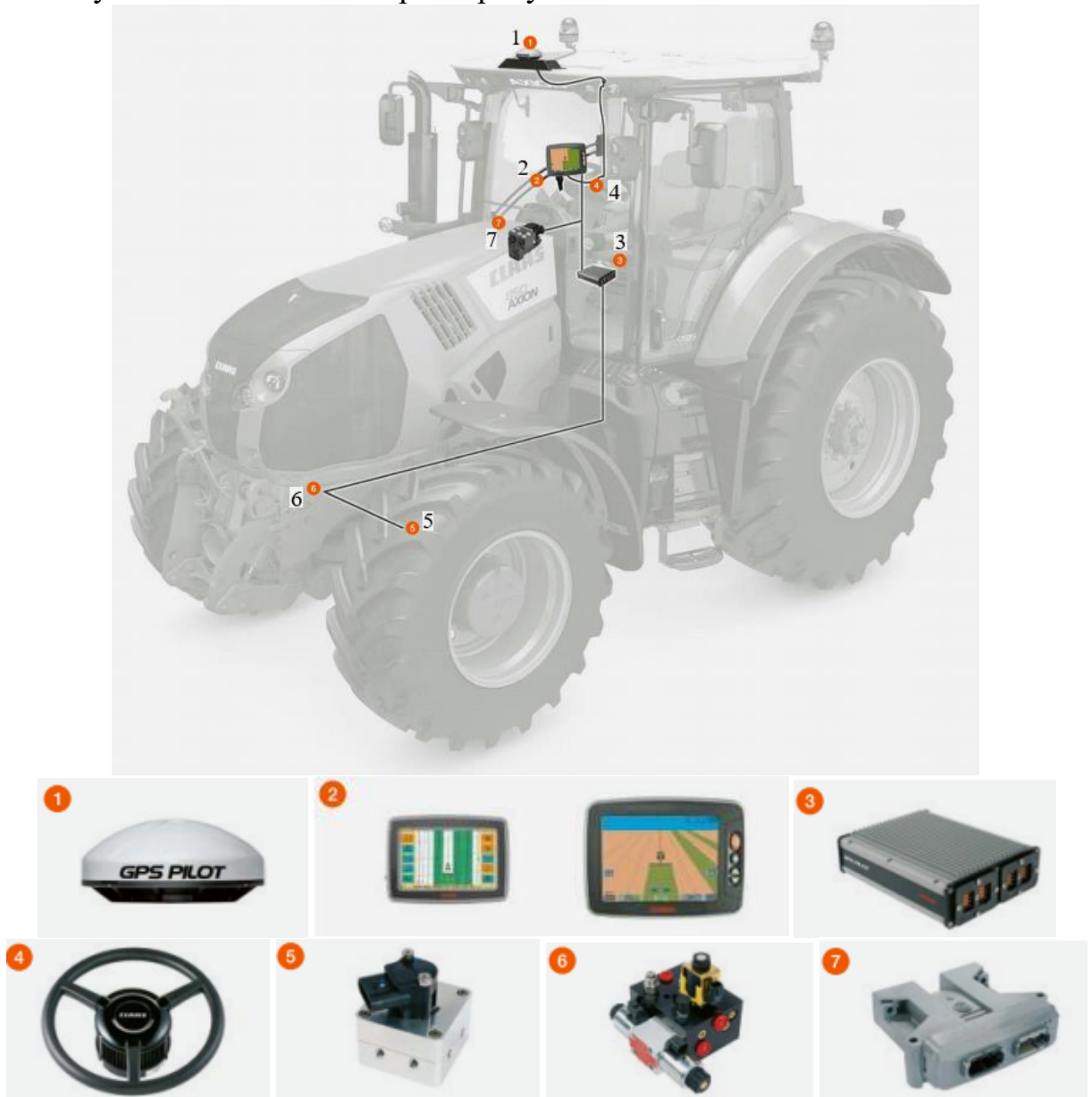
Рис. 2.5 - Компоненти GPS PILOT і GPS PILOT FLEX: 1 - антена GPS PILOT; 2 - термінал S7, S10; 3 - навігаційний комп'ютер; 4 - електричне рульове колесо; 5 - датчик кута повороту рульового колеса; 6 - пропорційний клапан; 7 - електронний блок керування клапаном
