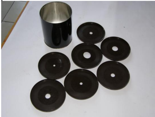
Рис. 5. Циліндрична ємність для преміксів і набір змінних діафрагм з отворами різного діаметра
