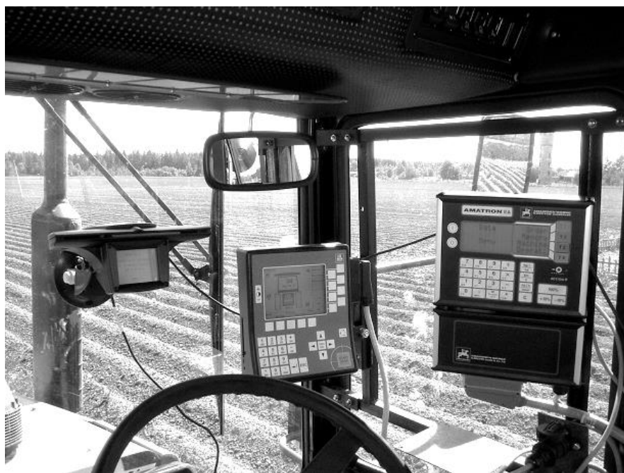
Рис.32 Бортові комп'ютери Amatron і Hydro, а також контролер курсу в кабіні трактора
