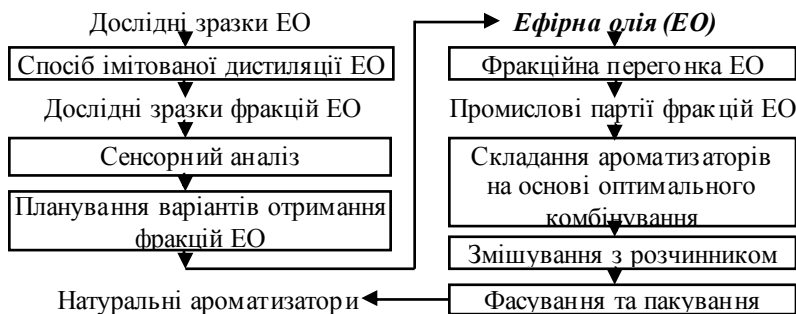
Рисунок 2 – Принципова технологічна схема отримання ароматизаторів із ефірних олій (ЕО)
