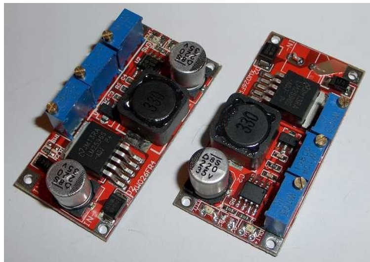
Рис. 5. Імпульсний стабілізатор струму\напруги на LM2596:
