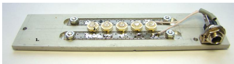
Рис. 3. Лінійка з п'яти світлодіодів: 1 – алюмінієва планка-радіатор; 2 – УФ-світлодіод; 3 – рознімач живлення УФ-випромінювача
